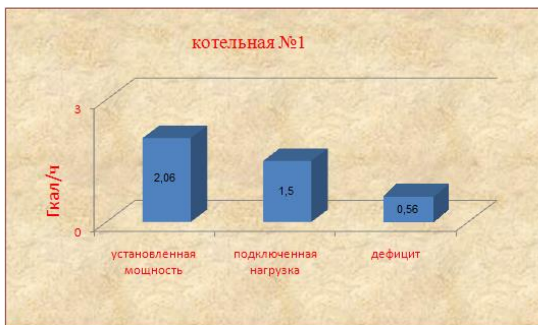
Рисунок 2.2.1 Тепловой баланс котельной №1
